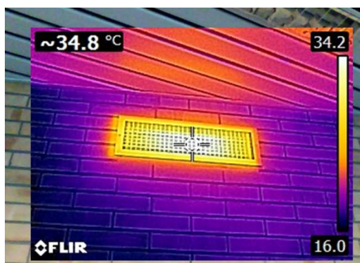
Figura 2.11: Immagine termografica di un terminale aeraulico.
