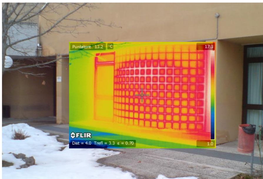
Figura 2. 33: Immagine IR e fotografica del prospetto Sub-Est: particolare parete esterna in vetrocemento.
