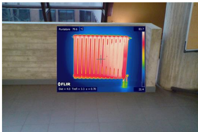
Figura 2. 19: Immagine IR di un radiatore nell'atrio principale della struttura.
