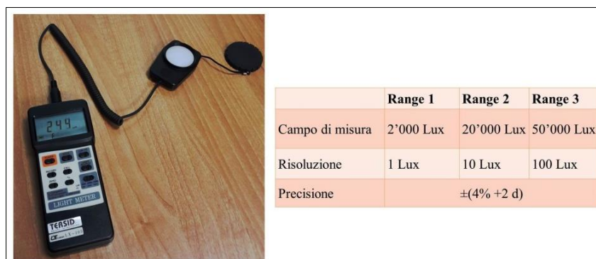
Figura 2. 19: Caratteristiche del luxmetro.
