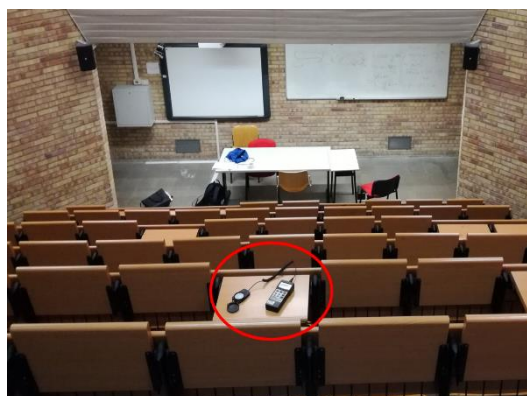
Figura 2. 36: Aula Q: misura illuminamento posizione 1.
